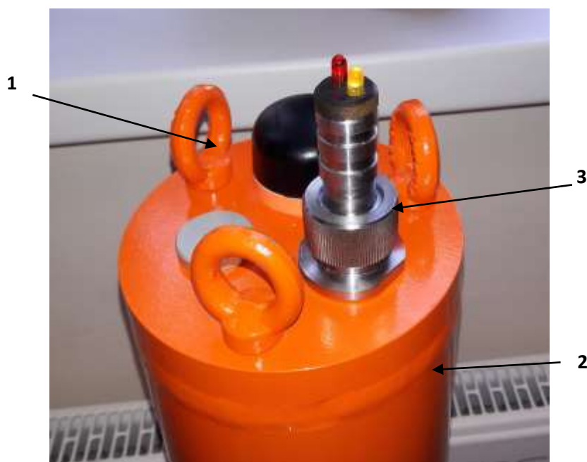
Рис. 16. Верхняя крышка корпуса гео-гидроакустического модуля: 1 – внешняя антенна Wi-fi/GPS, 2 – герметичный разъем типа PC-10, 3 – светоиндикаторная заглушка
