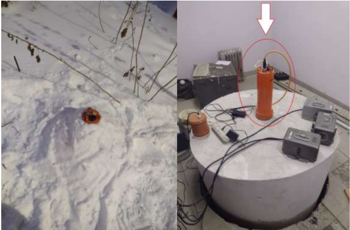
Рис. 11. Измерительное оборудование: слева – переносная сейсмостанция, используемая в различных точках исследуемой территории, справа – сейсмостанция, расположенная на опорном пункте – на постаменте подвального помещения КПЦ ИФЗ РАН
