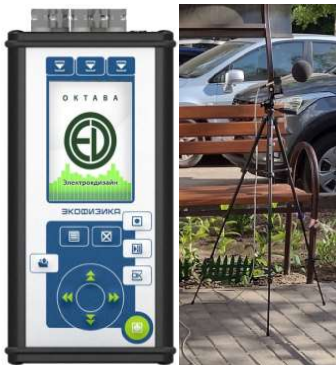
Рис. 41. Акустический шумомер ОКТАВА «ЭКОФИЗИКА 110-А»: слева – измерительный блок, справа – микрофонный капсюль с предусилителем и ветрозащитой на треножном штативе
